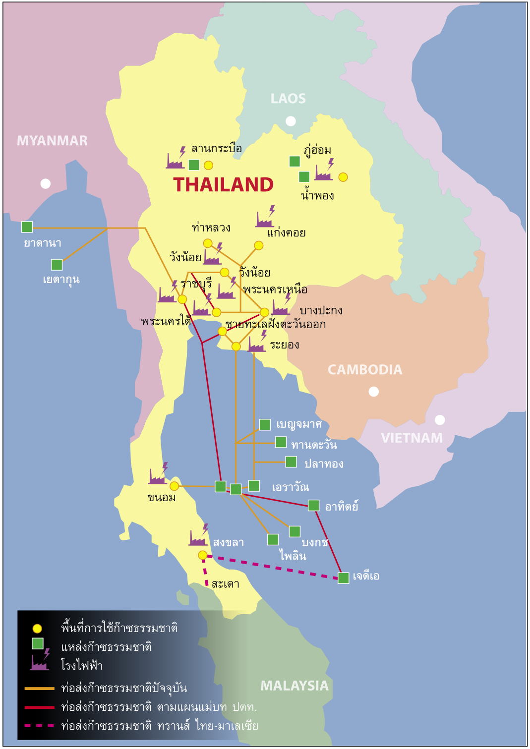
ระบบโครงข่ายท่อส่งก๊าซธรรมชาติตามแผนแม่บทระบบท่อส่งก๊าซธรรมชาติ ฉบับที่ 3 พ.ศ. 2544 - 2554 (ปรับปรุง)
